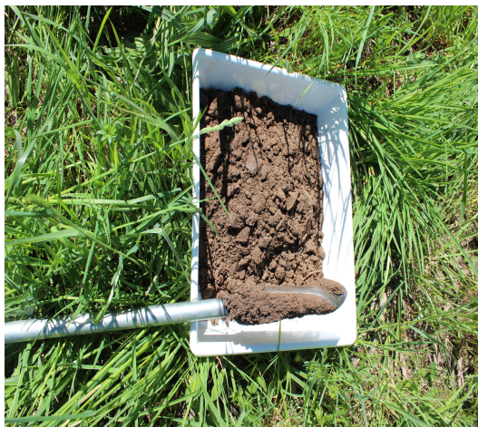
Figure 12 : Prélèvement de sol, émottage et homogénéisation pour la réalisation d'un échantillon composite
